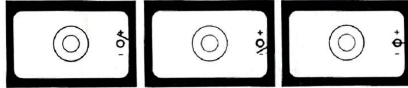
Наблюдая в окуляр видоискателя так, чтобы хорошо была видна вся его кадровая рамка, нажмите спусковую кнопку 3 до ощутимого упора, но не до срабатывания затвора, если он введен.
