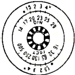
Прибор не позволяет учитывать светофильтр с кратностью более 1,5 $\times$  при чувствительности 22 ед. ГОСТ, более 2 $\times$  — при чувствительности 32. При чувствительности 16 кратность светофильтра не учитывается. Эта особенность распространяется соответственно и на шкалу чувствительности, в градусах DIN.
