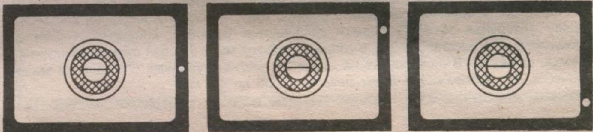
Глядя в окуляр видоискателя так, чтобы хорошо была видна вся его кадровая рамка, нажмите спусковую кнопку 5 до ощутимого упора, но не до срабатывания затвора, если он введен, и удерживайте кнопку в таком положении.
