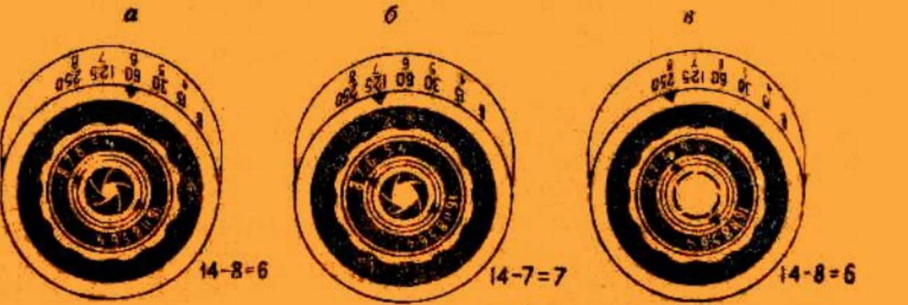
При пользовании экспозиционными шкалами необходимо определить экспозиционное число, которое представляет собой сумму двух условных чисел, устанавливаемых на шкалах. Экспозиционное число определяется экспонометром с экспозиционной шкалой.
