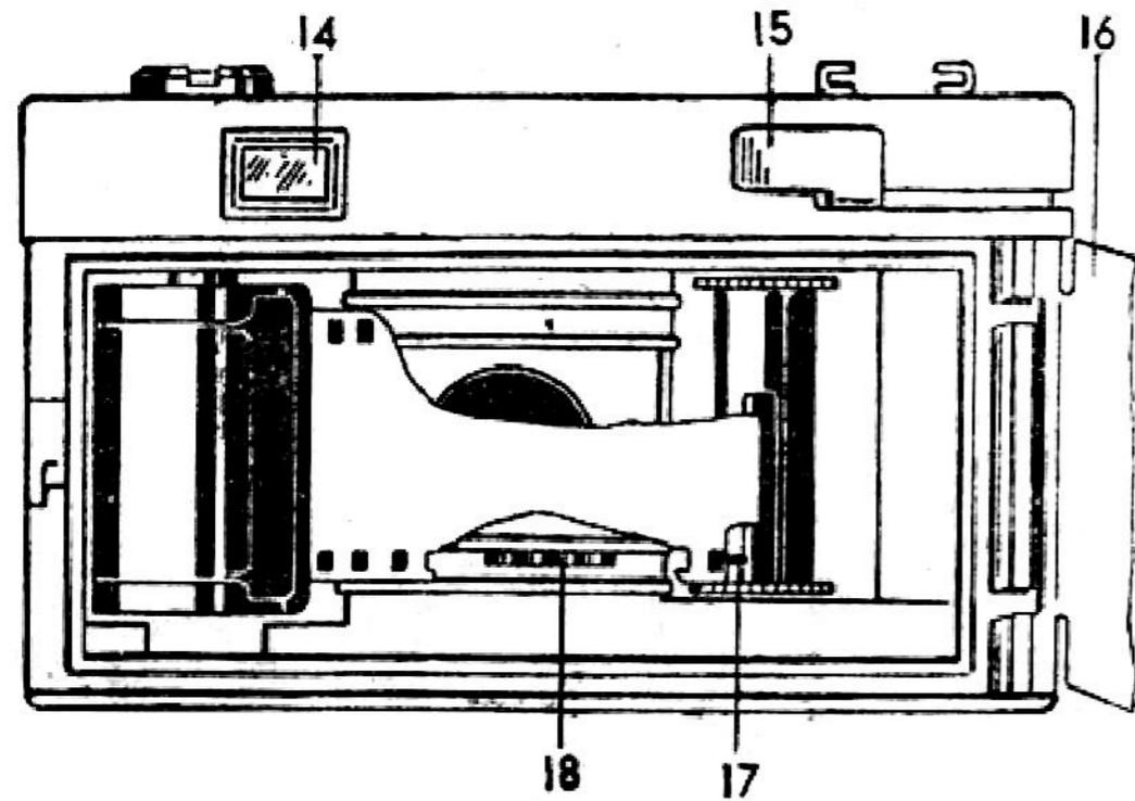
Рис. 2. Фотоаппарат с открытой задней крышкой
