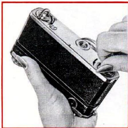
Рис. 6. Открывание замков на задней стенке
