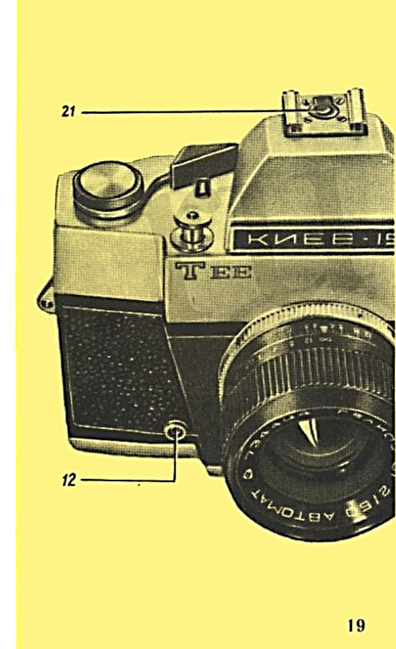
вспышек. Съемку с лампой-вспышкой следует производить только при отключенной автоматике на любой из выдержек от  $1/60$  до  $1/2$  с. При подключении лампы-вспышки через штепсельное гнездо 12 в обойму 21 необходимо вставить пластмассовый вкладыш для изоляции контакта.
