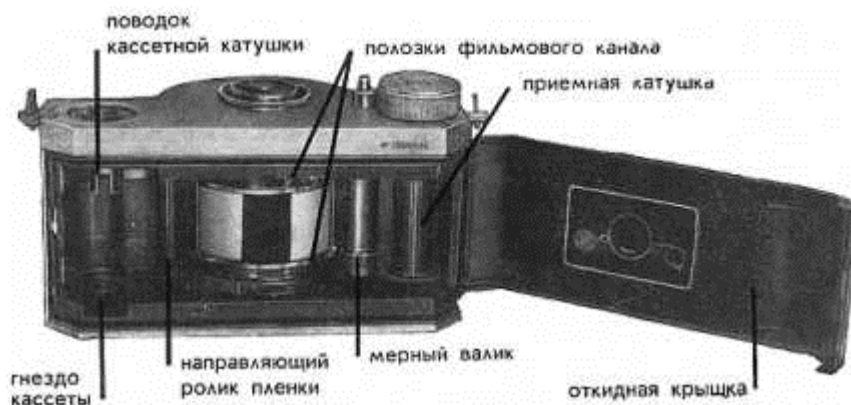
поводок кассетной катушки; ползки фильмового канала; приемная катушка; гнездо кассеты; направляющий ролик пленки; мерный валик; откидная крышка
