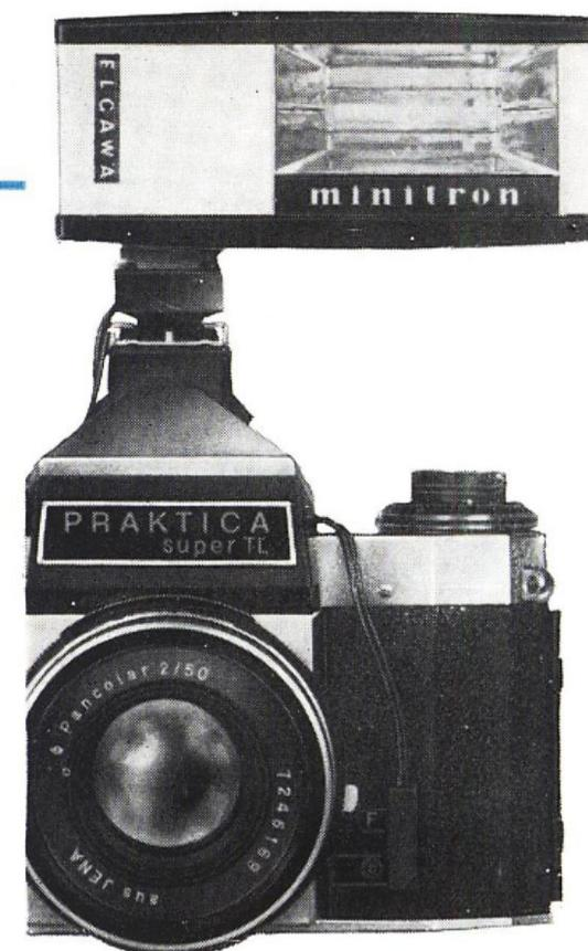
Устанавливаемое число диафрагмы получают делением указанного для лампы-вспышки или электронной вспышки «ведущего» числа на расстояние источника вспышки до предмета съёмки (в метрах).
