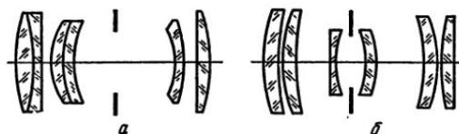
Рис. VI, 3. Оптические схемы телеобъектива «Теленоир» (а) и объектива «Фотон» (б)
