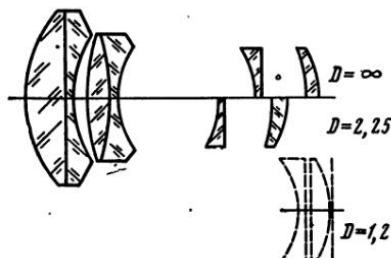
Рис. V, 27. Схема оптики аноморфотной широкугольной насадки НАС-5 в главном меридиональном (горизонтальном) сечении
