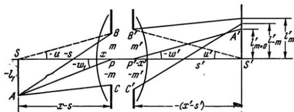
Рис. II, 7. Структура широкого меридионального пучка, обладающего комой
