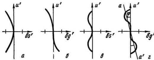
Рис. II, 5. Графическое представление сферической аберрации
