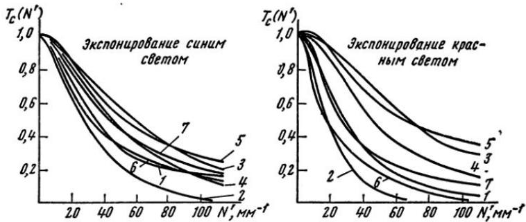
Рис. V. 1. Частотно-контрастные характеристики широкофотографических и любительских фотопленок: 1 — «панхромат 10»; 2 — «изопанхромат 13»; 3 — «изопанхромат 18»; 4 — «изопанхромат 20»; 5 — «фото-32»; 6 — «фото-250»; 7 — КН-3
