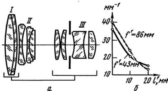
Рис. V, 13. Оптическая схема и кривые разрешающей силы объектива «Авто-Никкор-Зум» ( $f' = 43\text{--}86\text{ mm}$ )
