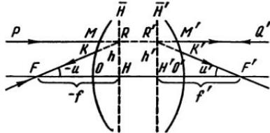
Рис. I, 19. Главные плоскости оптической системы
