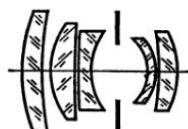
Рис. V, 11. Оптическая схема объектива «Вера-13»
