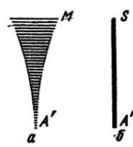
Рис. II, 16. Изображение отрезка прямой астигматическими пучками
