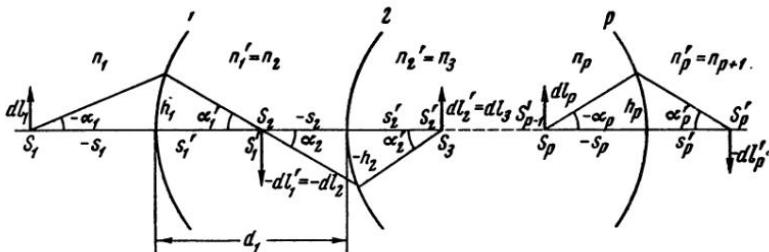
Рис. I, 17. Последовательные изображения, образуемые системой преломляющих поверхностей
