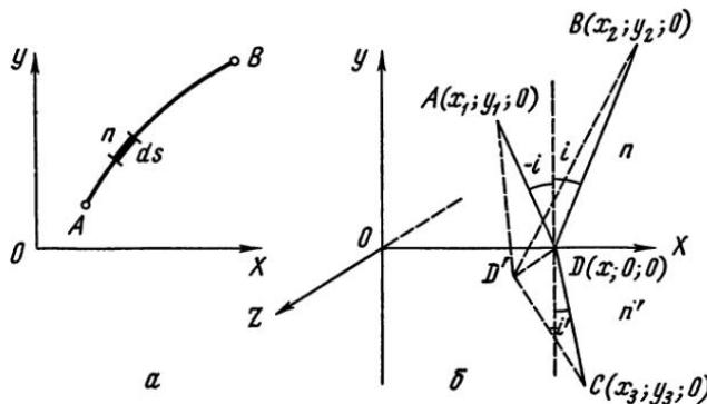
Рис. I. 5. Объяснение явления отражения и преломления лучей на основе принципа Ферма
