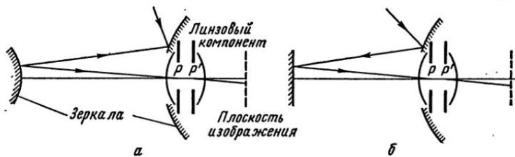
Рис. IV, 19. Оптические схемы широкоугольных дисторгирующих зеркально-линзовых объективов: а — с малым сферическим зеркалом; б — с малым плоским зеркалом
