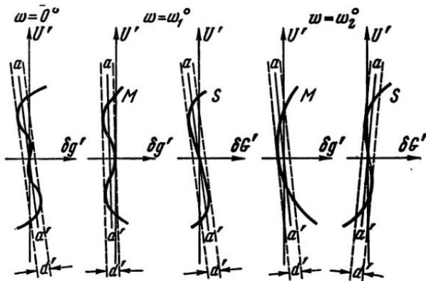
Рис. III, 12. Эффективные размеры  $d'$  фигур рассеяния лулей в плоскости установки  $aa'$
