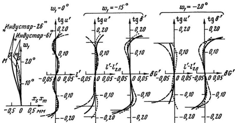
Рис. IX. 4. Графики aberrаций объективов «Индустар-61» (сплошные кривые); «Индустар-26» (пунктирные кривые); «Индустар-61А» (точечные кривые)
