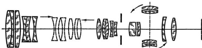
Рис. VIII, 4. Оптическая схема панорамического объектива «Алькор-6» ( $f' = 80-800 \text{ мм}$ )
