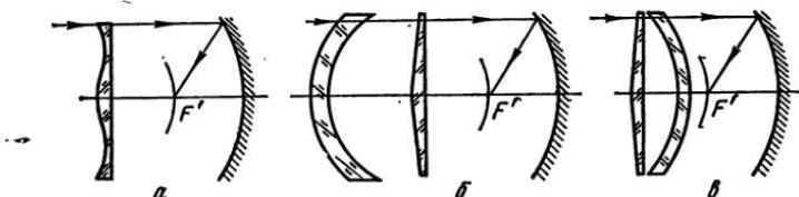
Рис. IV, 16. Оптические схемы особосветосильных зеркально-линзовых систем: *а* — Шмидта; *б* — Бауэрса; *в* — Волосова — Бабинцева
