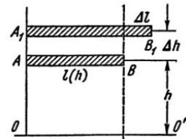
Рис. II, 38. К определению изменения формы оптической детали при ее неравномерном нагревании
