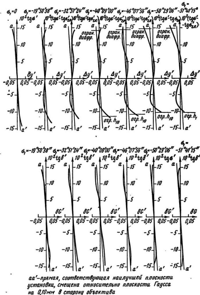
Рис. V. 32. Аберрации широких наклонных пучков объектива «Ликар-3»
