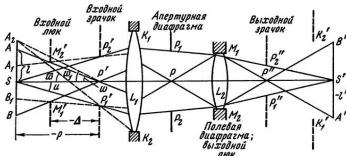
Рис. I, 29. Ограничение пучков лучей в оптической системе
