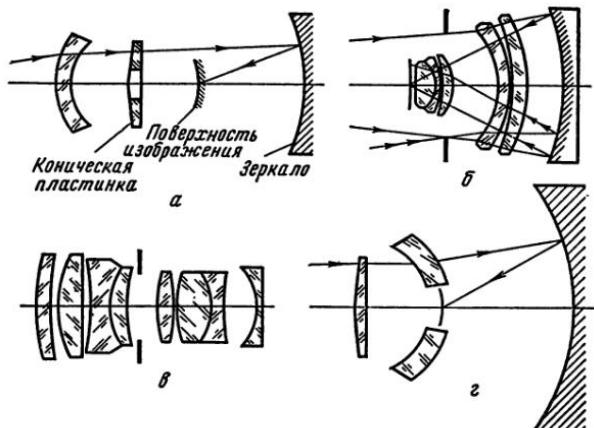
Рис. VI, 19. Оптические схемы особо светосильных систем для флюорографии: а — А. Бауэрса; б — фирмы «Канон»; в — Г. Цельнер; г — Д. Волосова — В. Бабинцева
