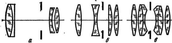
Рис. IV, 9. Оптическая схема объективов: а — Петцвала; б — «Кук-анастигмата»; в — «Планара» — «Гелиоса»
