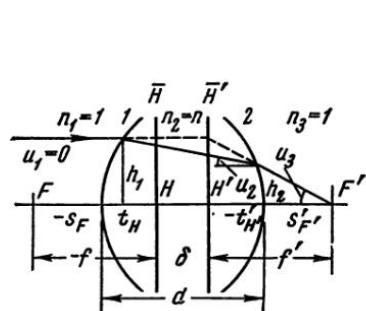
Рис. I, 26. Преломление луча в линзе конечной толщины
