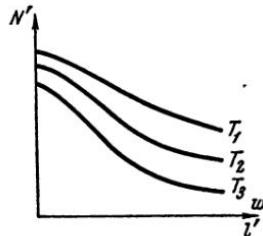
Рис. III, 18. Характеристика объектива по полю семейством кривых ФПМ
