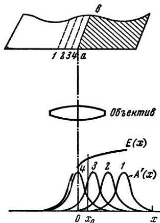
Рис. III, 7. Распределение освещенности в изображении края полуплоскости
