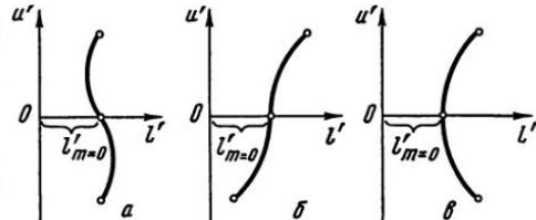
Рис. II, 9. Графическое представление аберрации меридиональной комы
