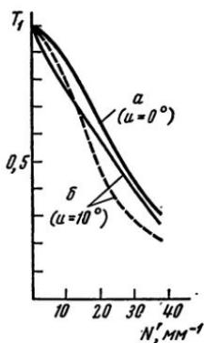
Рис. VIII, 7. Расчетные ЧХХ объектива «Гелиос-95А-Т»: а — в центре поля; б — для угла поля зрения  $10^\circ$  (пунктиром указано меридиональное направление штрихов меры, сплошной линией — сагиттальное направление)
