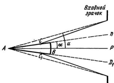
Рис. I, 36. Изображение объемного предмета особо светосильным объективом
