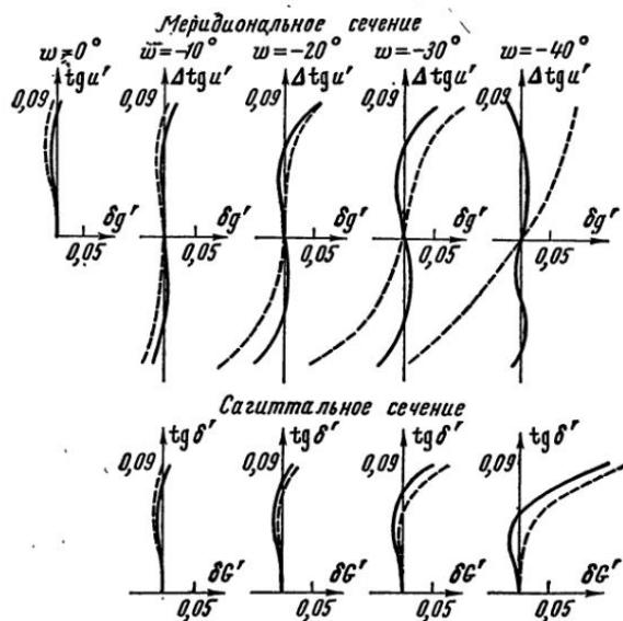
Рис. IX, 14. Аберрации широких наклонных пучков до и после автоматической коррекции широкогоугольного объектива
