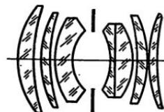
Рис. V, 17. Оптическая схема светосильного объектива «Восход-2» ( $f'=32 \text{ mm}$ ,  $1:1,6$ )
