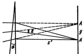
Рис. I, 14. Отклонение пучка лучей оптическим клином
