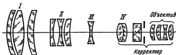
Рис. V, 41. Оптическая схема панкратического объектива «Анжене-Зум 8×6,5»
