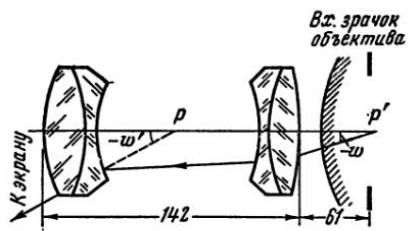
Рис. VII, 2. Схема анаморфотной насадки НАП2-2 в меридиональном сечении
