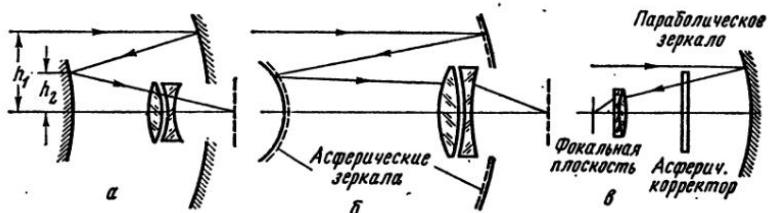
Рис. IV, 18. Схемы зеркально-линзовых систем: а — Чуриловского—Росса; б — Кассегрена с асферическими зеркалами; в — Вина
