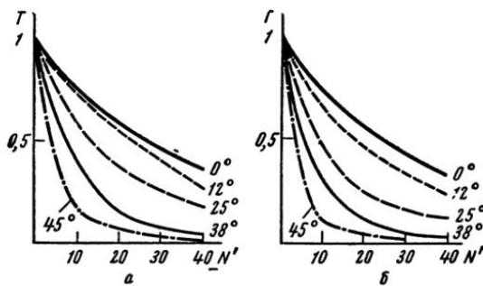
Рис. VI. 9. Частотно-контрастные характеристики объектива «Ламегон» (ГДР) для разных углов поля зрения при относительных отверстиях: а —  $1 : 4,5$ ; б —  $1 : 5,6$
