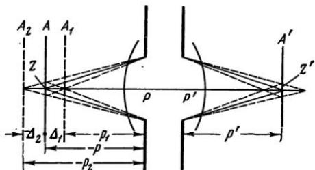
Рис. I, 37. Определение глубины резко изображаемого пространства предметов
