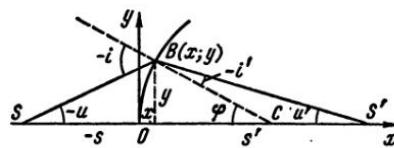
Рис. II, 28. Преломление луча через асферическую поверхность
