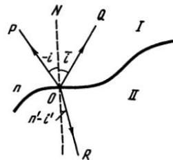
Рис. I, 4. Отражение в преломление луча
