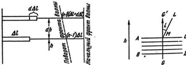
Рис. II, 39. Поворот фронта световой волны при неравномерном нагревании стекла
