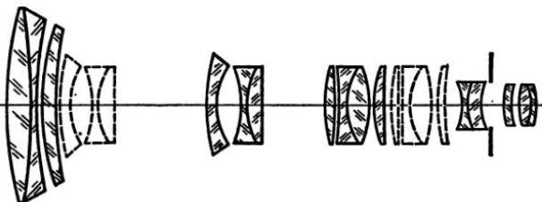
Рис. VIII, 10. Оптическая схема панкратического объектива «Варио-Гоир-3Т» ( $f'=15-150 \text{ мм}$ )
