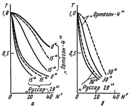
Рис. VI, 8. Частотно-контрастные характеристики объективов «Ортогон-4» и «Руссар-29» для сагиттального (пунктирные кривые) и меридионального (сплошные кривые) сечений в точках поля:  $a$  —  $0$  и  $15^\circ$ ;  $b$  —  $30^\circ$
