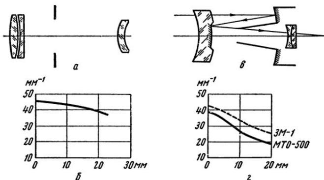
Рис. V, 12. Характеристики телеобъективов: а, б — линзового «Тарп-3»; в, г — зеркально-линзовых МТО-500 и ЗМ-1
