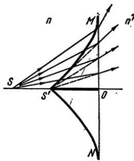
Рис. I. 10. Каустические поверхности, образованные широким пучком лучей, преломившихся через плоскость
