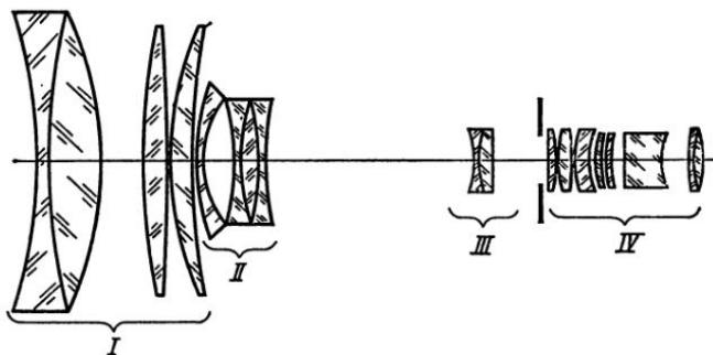
Рис. VIII, 5. Схема телевизионного панорамического объектива «Варио-Гонир-1Т» ( $f' = 40-400 \text{ мм}$ )
