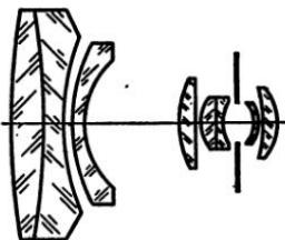
Рис. V. 29. Оптическая схема объектива ОКС4-40-1 ( $f' = 40$  мм)
