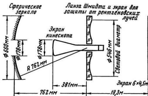
Рис. VIII, 12. Схема телепроекционной системы на большой экран
