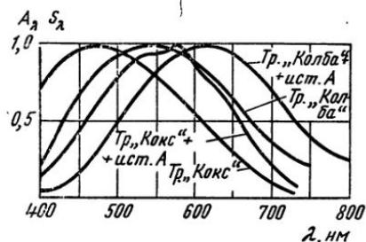
Рис. VIII, 1. Спектральные характеристики телевизионных трубок «Кокс» и «Колба» и актиничные потоки при источнике *A*
