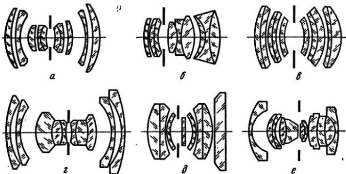
Рис. VI, 10. Оптические схемы топографических объективов: *a* — «Геогон-1»; *б* — «Авиотар»; *в* — «Пинатар»; *г* — «Авиагон»; *д* — «Топар»; *е* — «Ламегон»
