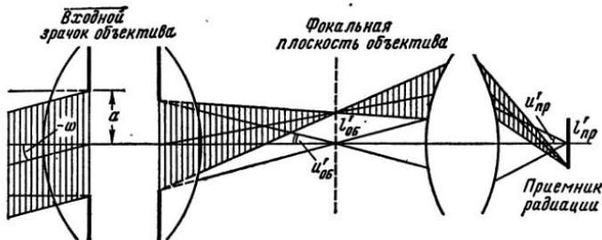
Рис. IV, 6. Оптическая схема следящей системы
