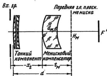
Рис. IV. 15. К расчету телеобъективов типа «Таир»
