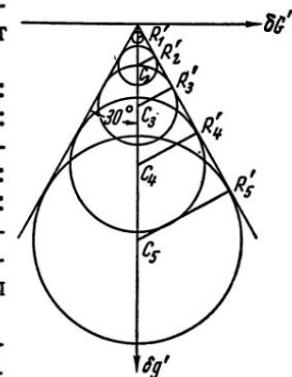
Рис. II, 6. Фигура рассеяния при aberrации комы третьего порядка
