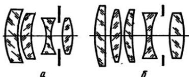
Рис. IV, 10. Оптические схемы объективов: а — «Калейнар»; б — «Эквитар»
