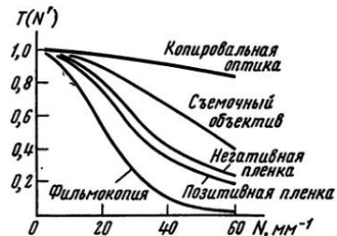
Рис. VII, 1. Частотно-контрастные характеристики отдельных звеньев производства кинофильма
