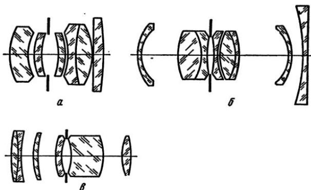
Рис. VI, 2. Оптические схемы объективов: *a* — «Аргон»; *b* — «Гоир»; *c* — «Марс-1»
