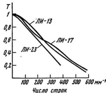
Рис. VIII, 3. Частотно-контрастные характеристики передающих телевизионных трубок в центре растра: суперортон ЛИ-13, ЛИ-17 и видикон ЛИ-23
