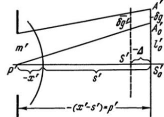
Рис. II, 12. Изменение aberrации  $\delta g'$  при перемещении плоскости установки
