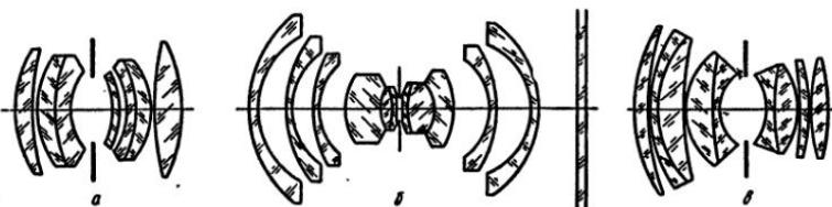
Рис. II, 31. Схема оптики анастигмата типа «Уран» (а), «Ортогон» (б), «Рекорд» (в)
