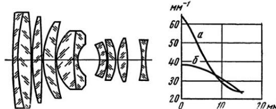
Рис. VI, 16. Оптическая схема объектива «Электрон-1» и графики его разрешающей силы на кинопленке тип 20: *a* — со светофильтром ЗС-8 и *b* — без светофильтра
