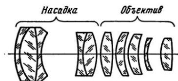
Рис. VII, 7. Схема крупногабаритных десятилинзовых анастигматов для широкоформатной кинопроекции 70-мм фильмов
