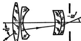
Рис. V, 28. Схема оптики «Бифокатор-5»
