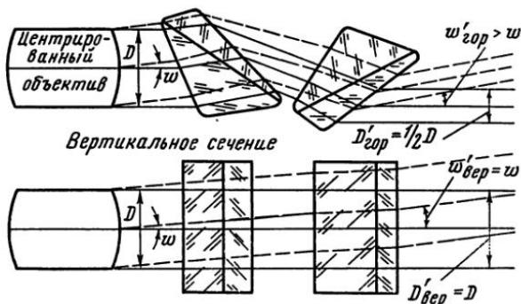
Рис. VII, 3. Схема призменной анаморфотной насадки
