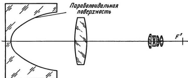
Рис. V, 35. Оптическая схема объектива «Супер-Тежеа» ( $f' = -5,7 \text{ мм}$ )
