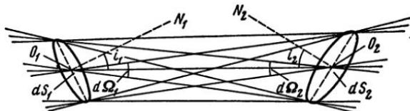
Рис. I, 1. Элементарная световая трубка
