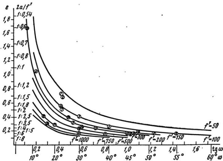
Рис. IV, 2. Диаграмма возможных оптических характеристик объективов
