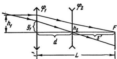
Рис. VI, 5. К проектированию двухкомпонентного телесистемы
