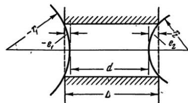
Рис. II, 34. К определению термического изменения величины воздушного промежутка
