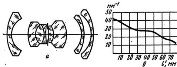
Рис. V, 19. Оптическая схема и графики разрешающей силы объектива «Биогон» ( $f' = 75 \text{ мм}$ )
