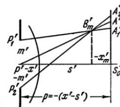
Рис. II, 14. Определение положения меридионального фокуса астигматического пучка
