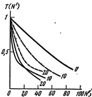
Рис. III, 15. Функции передачи модуляций объектива «Мир-1» для точек поля 0, 10, 20 мкм (— — мериодическое сечение; - - - — сагиттальное сечение)
