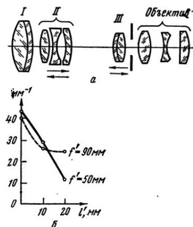
Рис. V. 18. Оптическая схема и графики разрешающей силы объектива «Зуко-Авто-Зум» ( $f' = 50-90$  мм)
