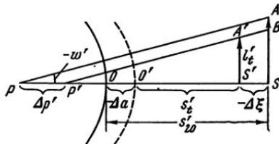
Рис. II, 35. К определению термооптических аберраций
