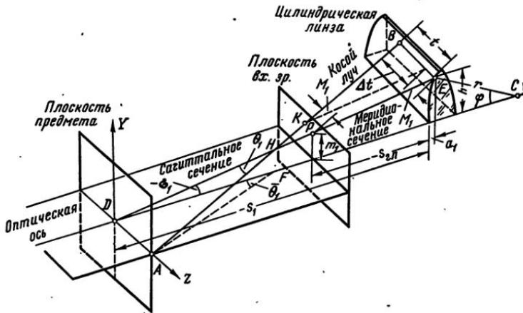
Рис. V, 24. Ход косого луча в аноморфотных системах
