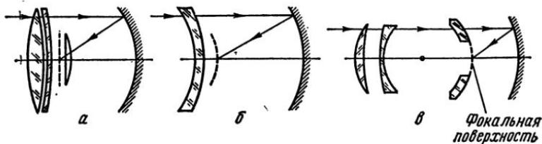
Рис. IV, 17. Зеркально-линзовые системы со сферическими поверхностями; *a* — Волосова — Гальперна — Печатниковой; *б* — Максутова; *в* — Вина
