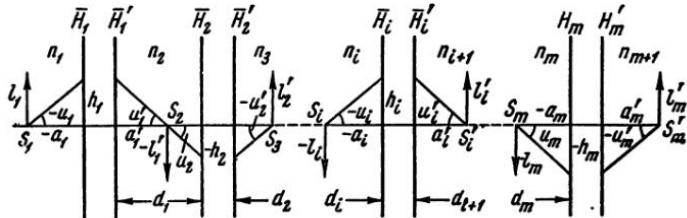
Рис. I, 25. Ход луча через многокомпонентную оптическую систему
