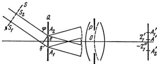
Рис. III, 5. Распределение освещенности в изображении двух несамосветящихся точек
