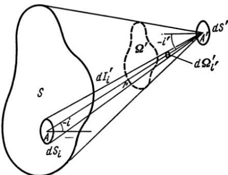
Рис. I, 39. К расчету освещенности в общем случае
