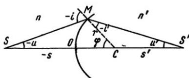
Рис. I, 15. Преломление луча через сферическую поверхность
