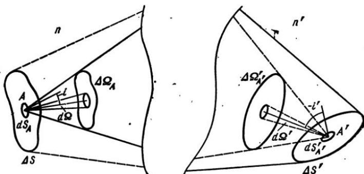
Рис. IV, 4. К формулировке общего инварианта для световых трубок конечных размеров
