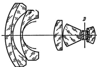
Рис. V, 31. Оптическая схема асферического объектива «Ликар-3» ( $f' = 22 \text{ mm}$ )
