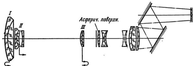
Рис. VIII, 11. Схема панклатического телевизионного объектива «Варотал-3»
