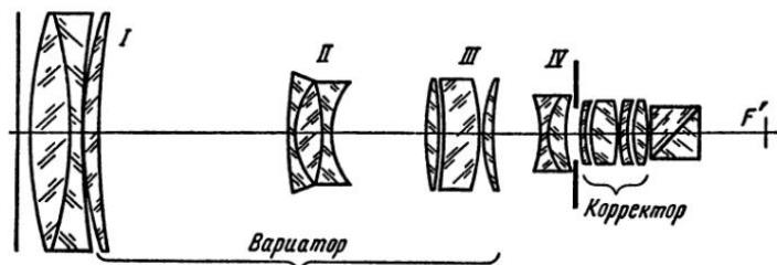
Рис. V, 42. Оптическая схема объектива «Варио-Гоир-2» ( $f'=6,6-66$  мм)
