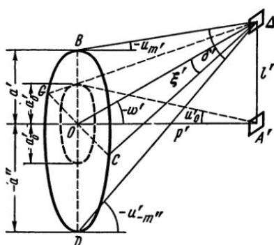
Рис. I. 42. К расчету освещенности изображения вне оси
