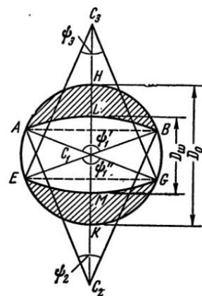
Рис. I, 30. Схема двустороннего виньетирования
