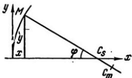
Рис. II, 29. К расчету астигматического пучка через асферическую поверхность
