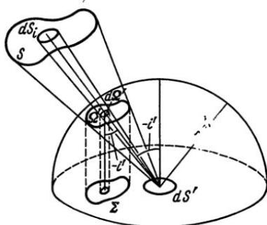
Рис. I, 40. Освещенность от больших поверхностей постоянной яркости
