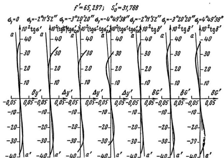
Рис. VII, 6. Аберрации панорамического проекционного объектива «Варио-Ликар-П» при фокусных расстояниях: а —  $f'=35$  мм; б —  $f'=65$  мм
