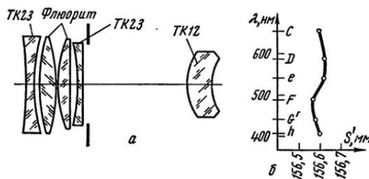
Рис. IX, 5. Объектив-апохромат «Апатаир-1»: а — оптическая схема; б — кривая вторичного спектра
