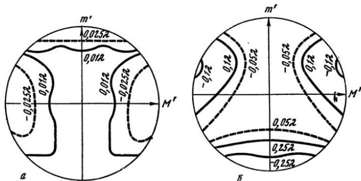
Рис. II. 23. Кривые равных волновых аберраций объектива «Эра-7» с  $f' = 105 \text{ мм}$  (a); кривые равных волновых аберраций объектива «Марс-1» с  $f' = 500 \text{ мм}$  (б)
