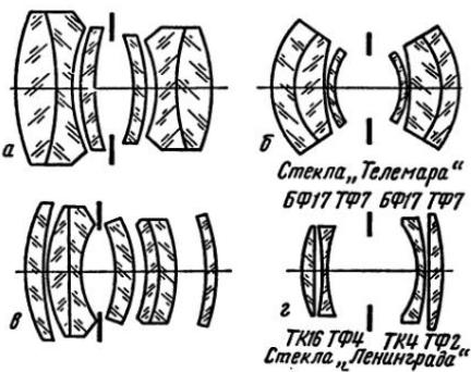
Рис. VI. 4. Оптические схемы объективов: *a* — «Арктик-А»; *b* — «Радон-1»; *c* — «Т-Уран-1»; *d* — «Телемар» — «Ленинград»
