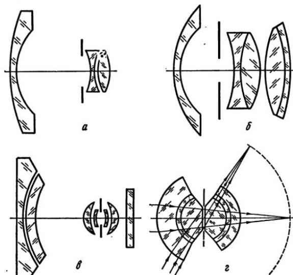
Рис. IV, 14. Схема дисторгирующих объективов: а — Гилль; б — Шульца; в — «Плеон» (фирма «Цейсс»); г — «Сферогон» (ГОИ)
