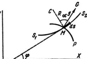
Рис. I, 6. Траектория луча в неоднородной оптической среде
