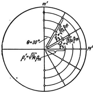
Рис. II, 22. Распределение координат лучей по зрачку
