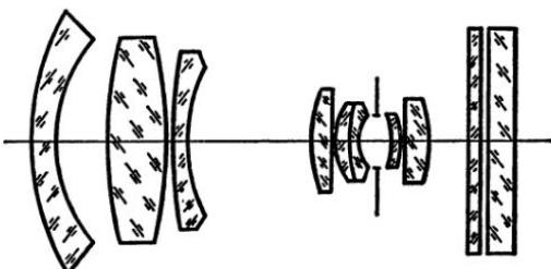
Рис. IX, 15. Оптическая схема телевизионного объектива «Мир-10Т»
