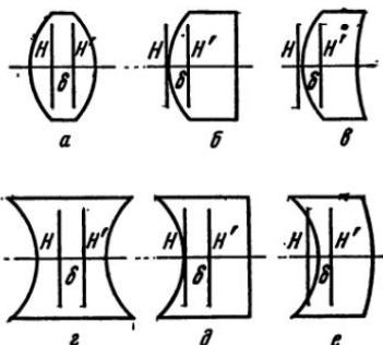
Рис. I, 27. Положение главных плоскостей в линзах различного вида
