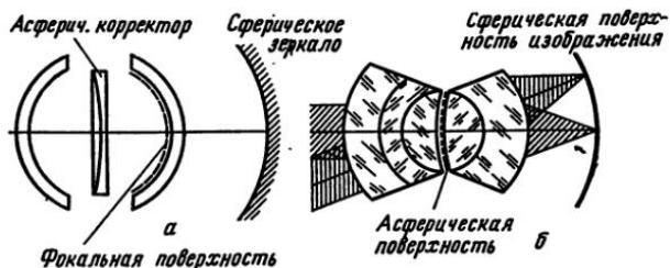
Рис. IX, 6. Концентрические системы: а — зеркально-линзовая «Супер-Шмидт»; б — линзовая Сферон
