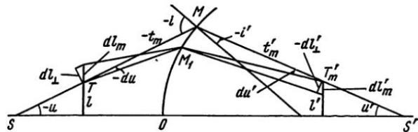
Рис. I, 23. Преломление элементарного астигматического пучка
