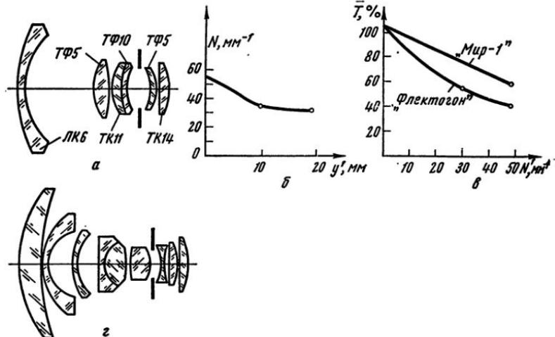
Рис. V, 9. Характеристики широкоугольного объектива «Мир-1» (а—е) и схема особо широкоугольного объектива «Мир-20» (е)
