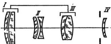
Рис. V, 16. Оптическая схема объектива «Астронар-Зум» ( $f' = 95—205$  мм)
