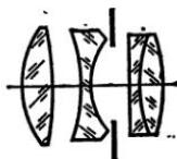
Рис. IV, 8. Оптическая схема объектива «Тессар»
