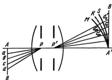
Рис. II, 15. Поверхности изображений, образуемые астигматическими пучками
