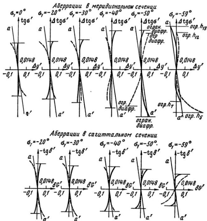
Рис. VI, 7. Графики аберраций объектива «Ортогон-4» (сплошные кривые) и объектива «Руссар-29» (пунктирные кривые)
