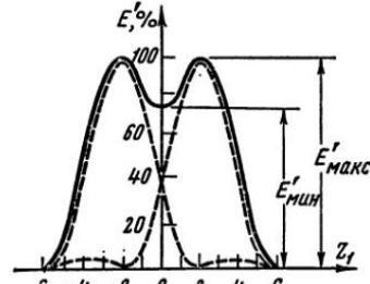
Рис. III. 3. Распределение освещенности в изображении двух самосветящихся точек
