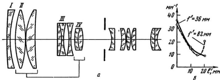
Рис. V, 14. Оптическая схема и кривые разрешающей силы объектива «Фойхтлендер — Зумар» ( $f' = 36-82 \text{ мм}$ )
