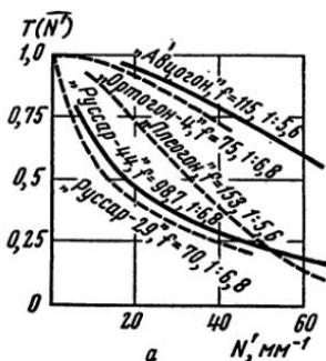
Рис. VI, 6. Частотно-контрастные характеристики широкугольных объективов
