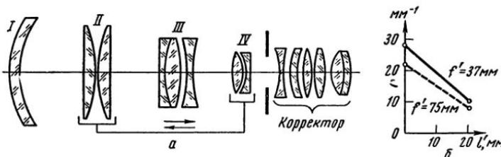
Рис. V, 15. Оптическая схема и кривые разрешающей силы объектива «Рубин-І» ( $f' = 37-80$  мм)
