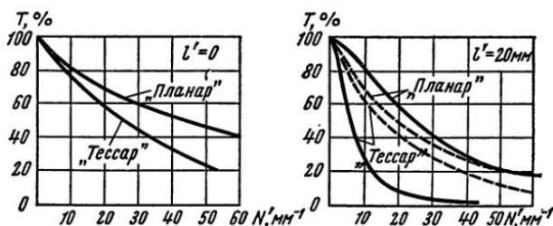
Рис. V. 6. Частотно-контрастные характеристики объективов «Планар» ( $f=50 \text{ mm}$ ) и «Тессар» ( $f=50 \text{ mm}$ )
