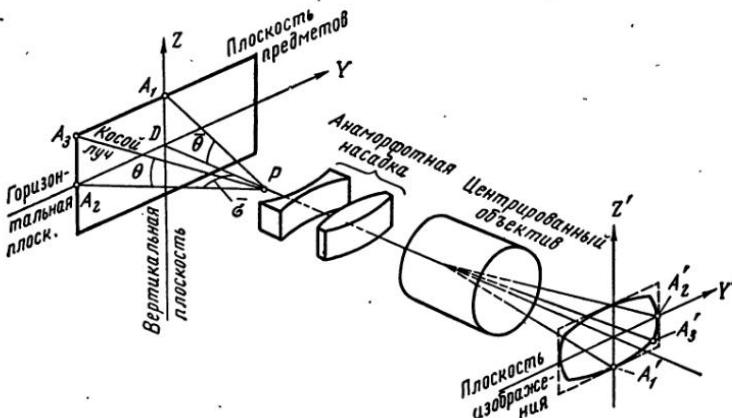
Рис. V. 25. Искривление вертикальных и горизонтальных линий анаморфотом
