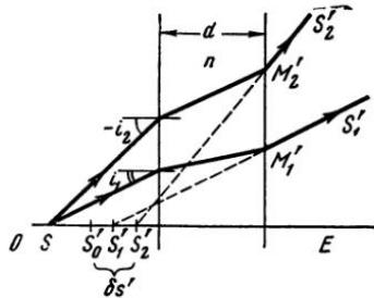
Рис. 1, 12. Сферическая aberrация пучка после его преломления через плоскопараллельную пластинку
