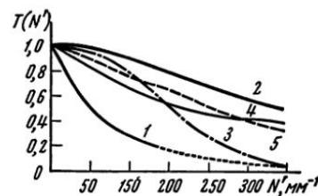
Рис. VI, 15. Частотно-контрастные характеристики звеньев системы ЭОП: 1 — зеркально-линзового объектива ОБ-114; 2 — кислородно-цеизевого фотокатода; 3 — электронной электростатической линзы; 4 — катодолюминесцентного экрана; 5 — микрообъектива
