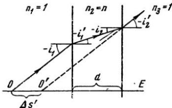
Рис. 1, 11. Преломление луча через плоскопараллельную пластинку
