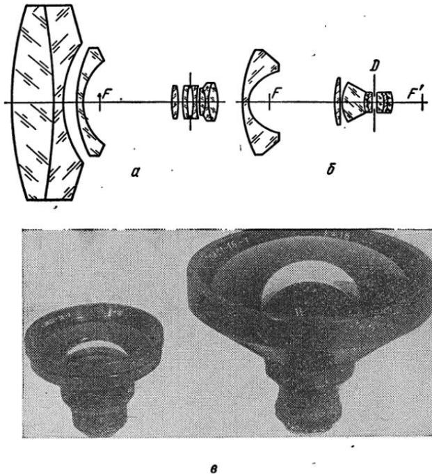
Рис. V. 21. Оптические схемы объективов: а — «Ликар-1» (OKC2-16-1); б — асферического объектива «Ликар-2»; в — внешний вид объективов OKC1-16-1 и «Ликар-1» (OKC2-16-1)
