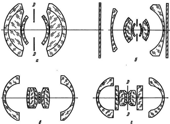
Рис. VI, 11. Оптические схемы отечественных объективов: а — «Орион-20»; б — «Ортогон-10»; в — «Рускар-29»; г — «Родина-26»
