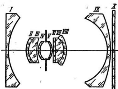
Рис. IX, 13. Оптическая схема широкоугольного объектива, автоматически корректированного на ЭВМ
