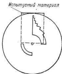
Рис. 119. Диск — модулятор экспозиции
