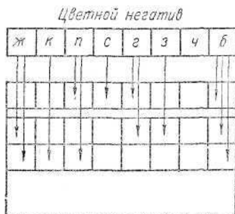
Образование скрытых изображений в слоях бумаги „Фоточет“
