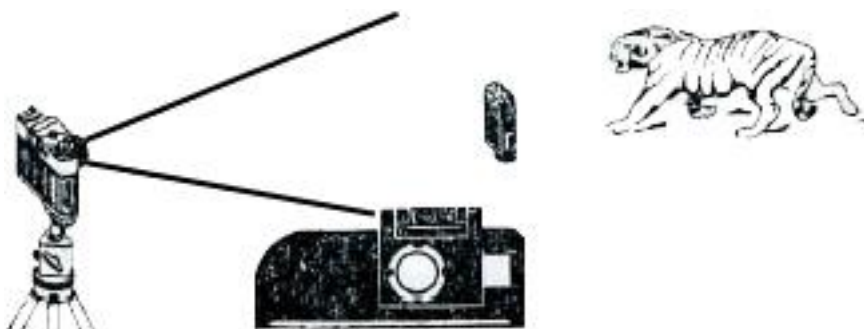
Рис. 9. Схема наводки экспонометра для измерения по освещённости
