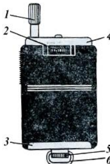
Рис. 7. Устройство приставки: 1 – колпачок; 2 – винт крепления приставки к экспонометру; 3 – скоба нажима; 4 – скоба верхняя; 5 – винт; 6 – скоба для шнура.
