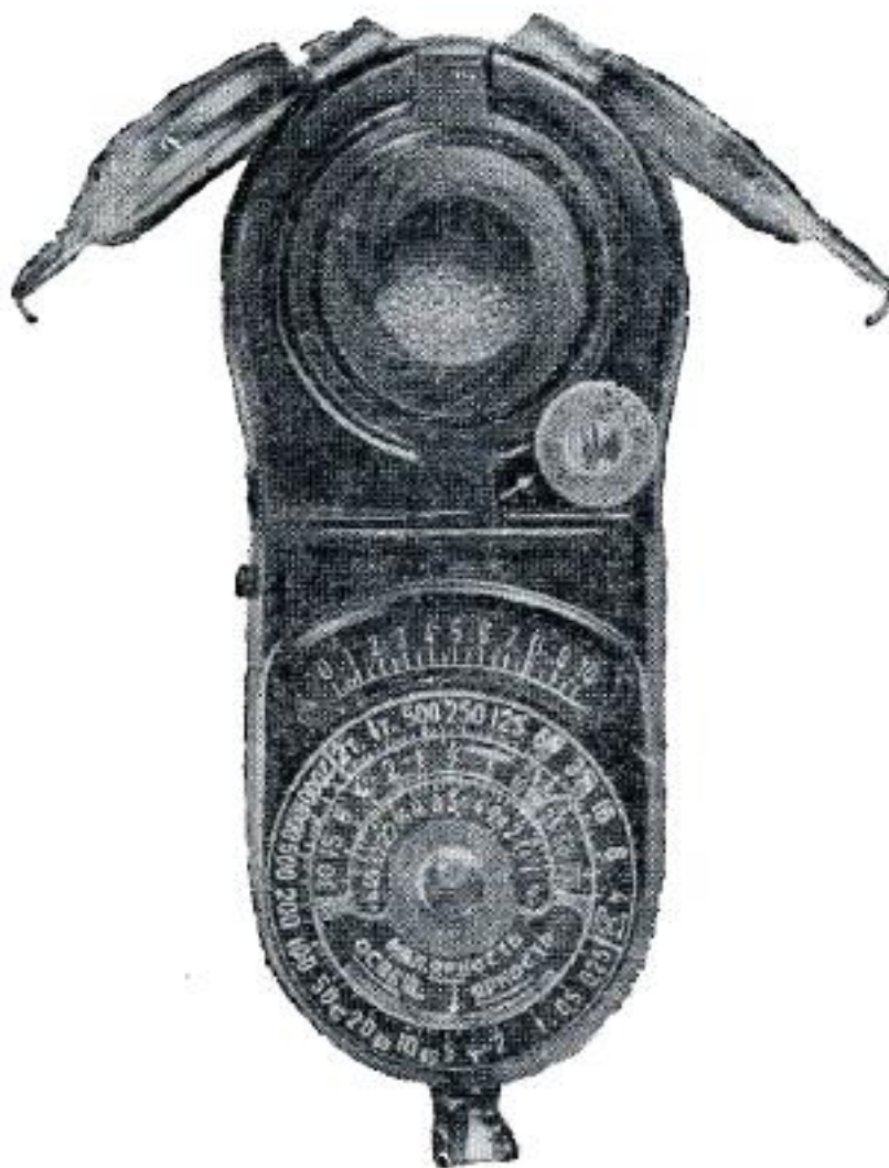
Рис. 1. Экспонометр ЭП-4. При измерении малых яркостей насадки для измерения яркости и освещённости расположены по бокам прибора, открывая отверстие шахты фотоэлемента
