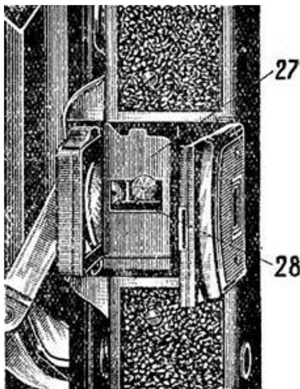
Видоискатель 5 состоит из двух линз в оправках-рамках и рамки-диафрагмы 27, вращающейся вокруг оси оправы большой линзы видоискателя. При открывании камеры нажатием на кнопку 1 видоискатель также открывается и рамки силою пружин устанавливаются в рабочее положение. Рамка-диафрагма служит для ограничения поля зрения видоискателя и выбора объекта съемки при фотографировании на кадр  $6 \times 6$  см. В рабочем положении в этом случае рамка 27 удерживается силой пружины.
