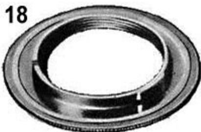
Конструкция аппарата «Киев-10» позволяет использовать в качестве сменных объективы к фотоаппарату «Зенит». Для этого в камеру устанавливают переходное кольцо (рис. 18), в которое ввинчивают объектив до упора. В этом случае механизм автоматической установки экспозиции не работает и диафрагмирование производится поворотом кольца диафрагмы объектива.
