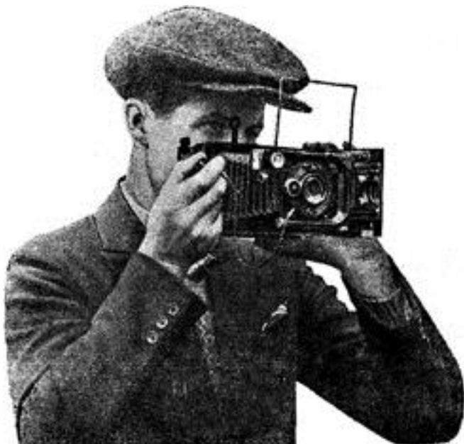
Рис. 26. Съёмка на уровне глаз и пользование иконометром.
