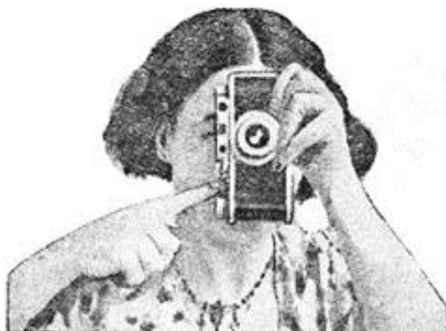
**Рис. 17.** Неправильное вертикальное положение аппарата.
