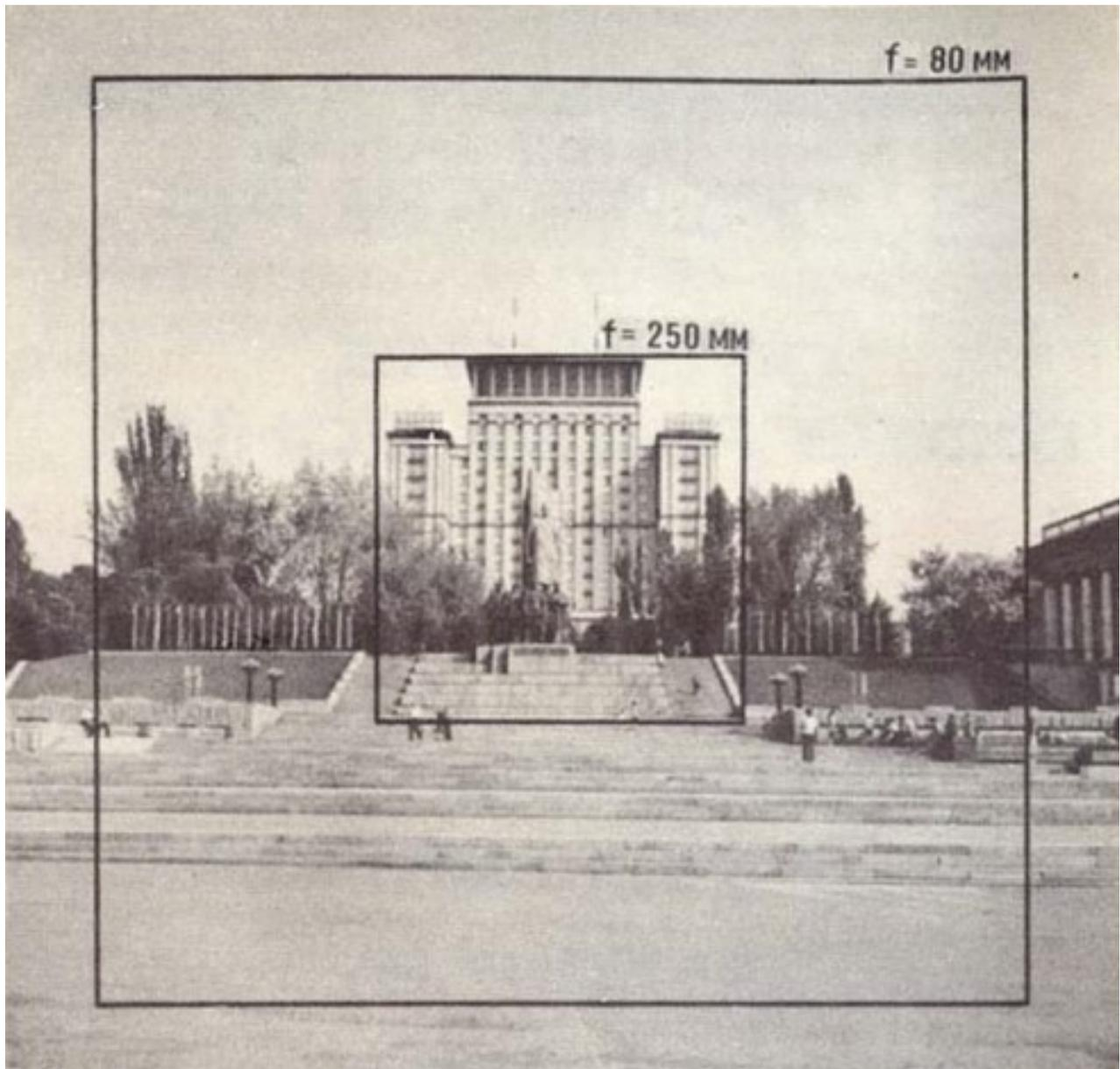
Объектив Юпитер-36Б расширяет возможности работы с фотоаппаратами Киев-6С и Киев-6С TTL. Он представляет собой длиннофокусную четырехлинзовую оптическую систему и позволяет получать фотографии высокого качества при съемках удаленных объектов, архитектурных деталей, животных, птиц и т. д.
