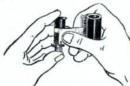
Рис. 4. Скрепление пленки с приемной катушкой
