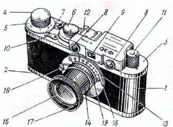
Рис. 1. Главнейшие детали камеры ФЭД
