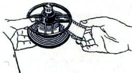
Рис. 18. Наматывание пленки на спиральную катушку
