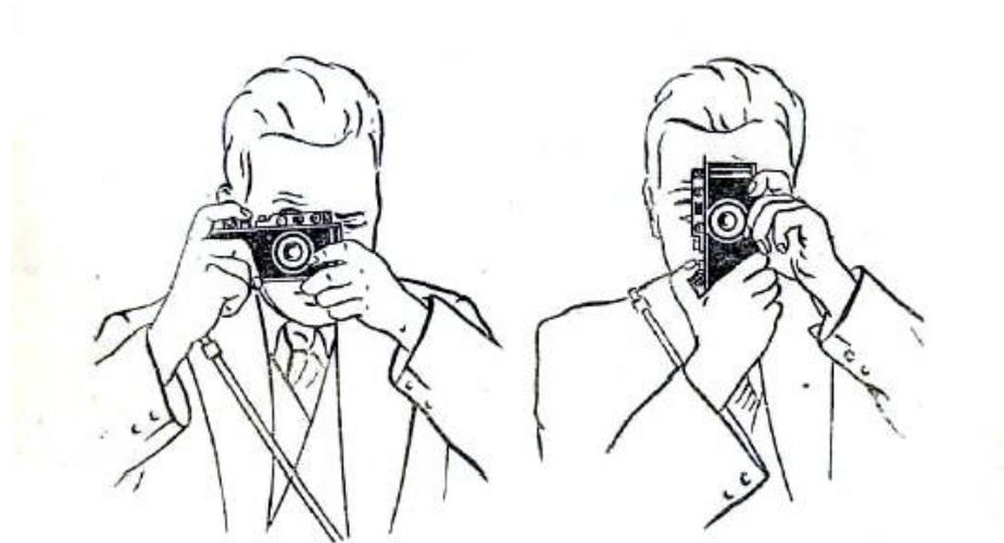
Рис. 6. Как следует держать камеру для съемки с рук
