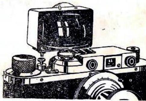
Рис. 15. Как укрепляется автоспуск на камере
