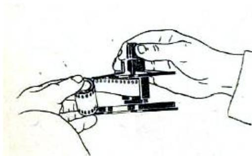
Рис. 17. Скрепление пленки с катушкой бачка
