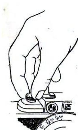
Рис. 7. Регулирование скорости затвора
