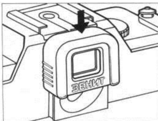
Оптический элемент насадки изготовлен из пластмассы и требует бережного обращения. Содержите насадку в чистоте, оберегайте от царапин, ударов, воздействия высокой температуры и агрессивных веществ (рис. 2).
